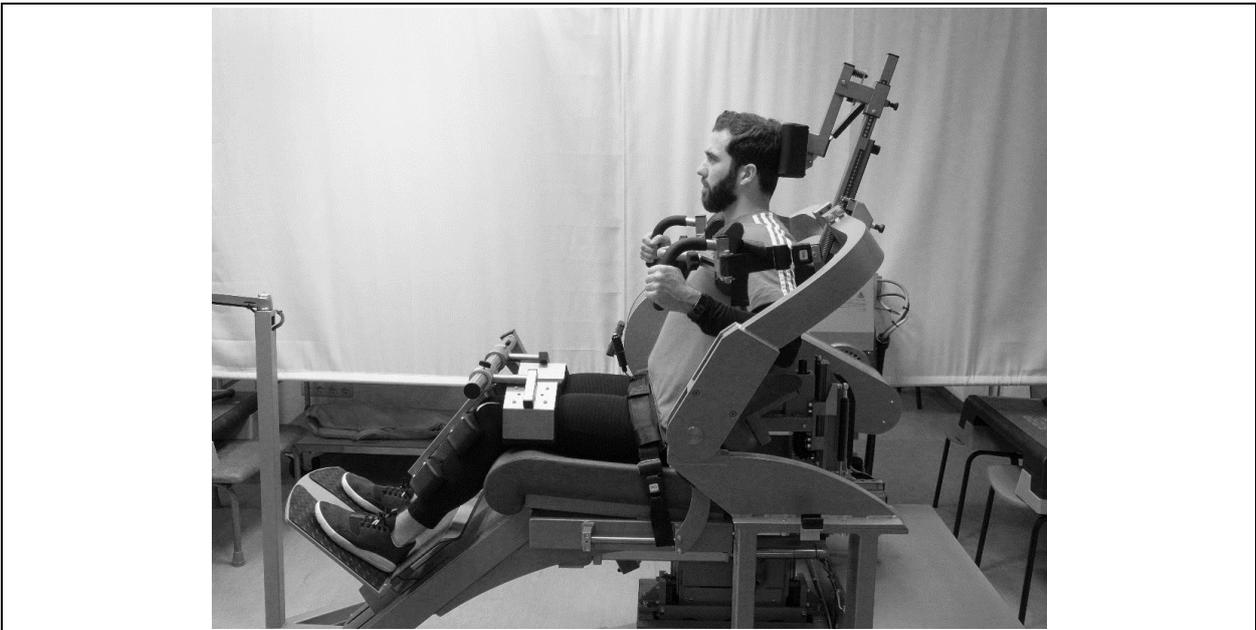
Abb. 4. Athlet befindet sich für den Test zur isometrischen Rumpfbeugung und -streckung in sitzender Position im „Back-Modul“ des IsoMed 2000 (Foto: IAT, Steven Pickardt & Steffen Kerner, 2015)
