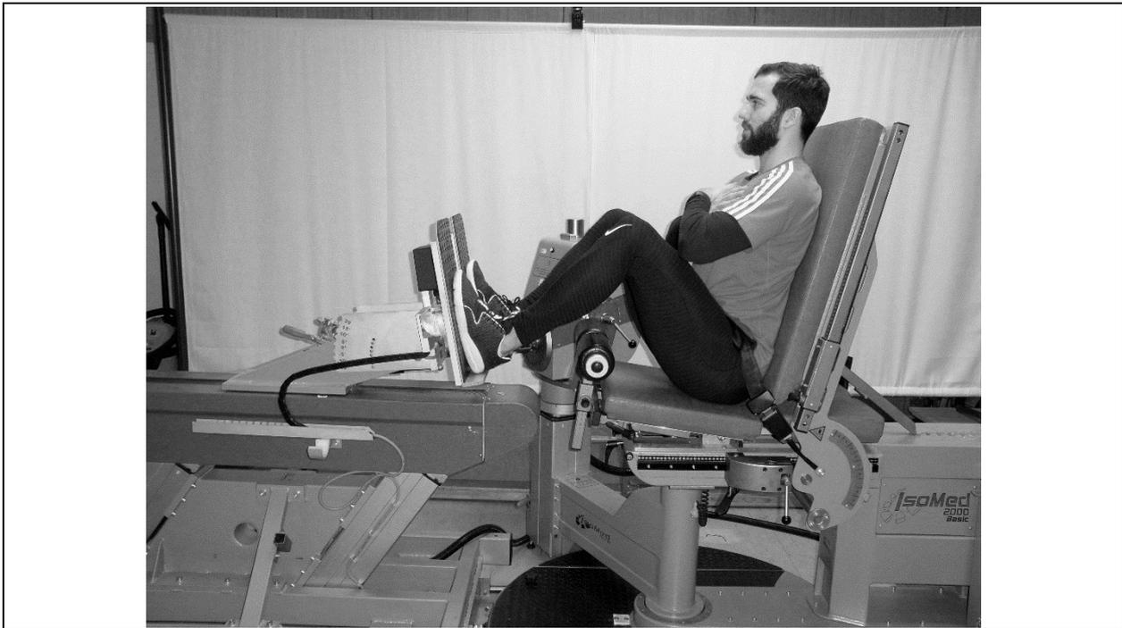
Abb. 1. Athlet befindet sich für den Test zur isometrischen Bein Streckung in sitzender Position im „Legpress-Modul“ des IsoMed 2000 (Foto: IAT, Steven Pickardt & Steffen Kerner, 2015)
